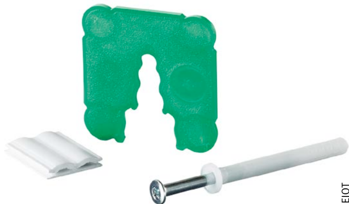
Afb. 36 Bevestigingsset voor profielen of rails (profielverbinder, stelblokje en plug).
