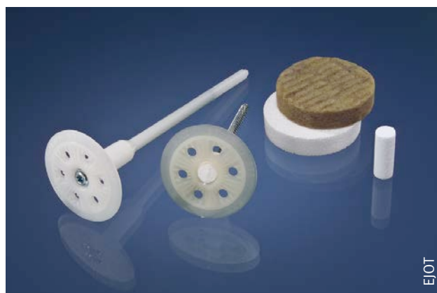
Afb. 18 Schotelbevestigingen met een isolatiedop of een isolerende sluitring waarmee de koudebruggen beperkt kunnen worden.
