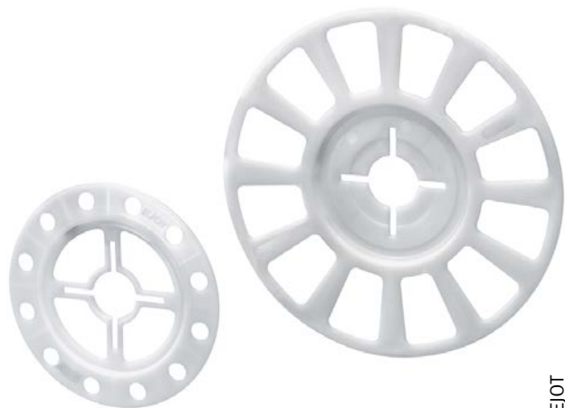
Afb. 15 Bijkomende schotels met een grotere diameter die indien nodig gecombineerd kunnen worden met een schotelplug.
