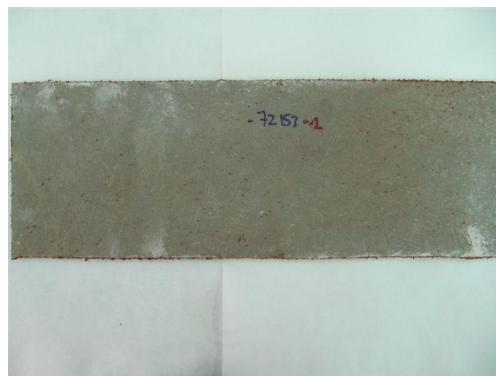
Stuk van glasvezel en geprojecteerde kurk aan een van de kanten
