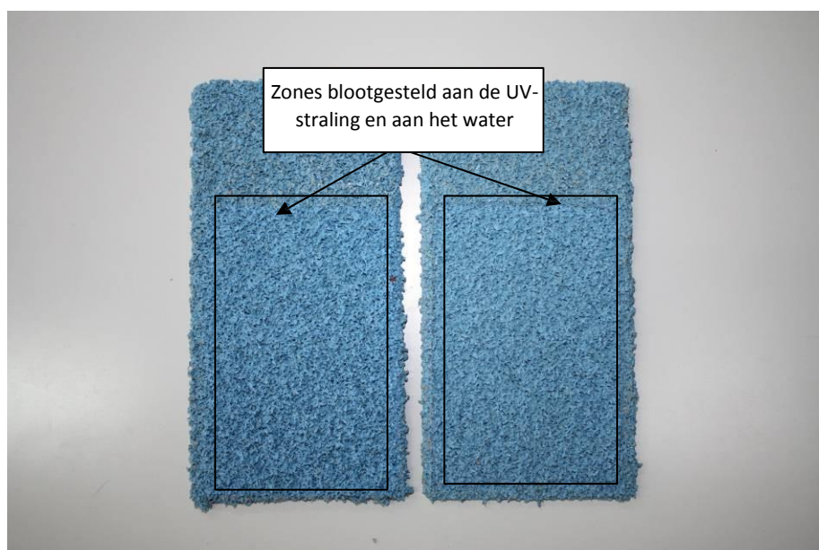
Afbeelding 2. Coating van geprojecteerde kurk DECOPROYEC na een blootstelling van 1000 uur aan de UV-straling en aan water
