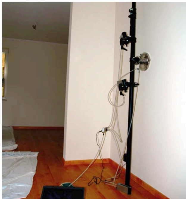
Afb. 15 Meting van de emissie van een verf in situ .
