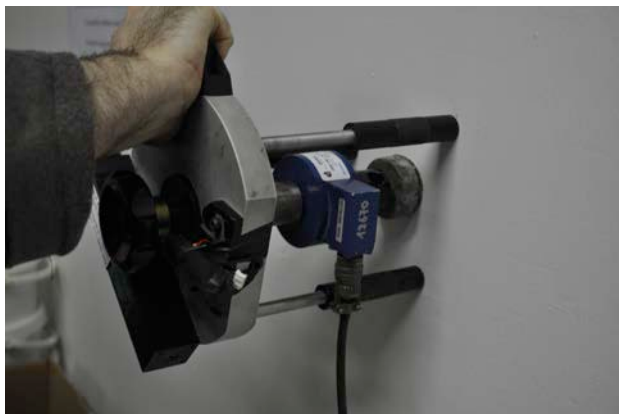
Afb. 22 Afbreekproef volgens de norm NBN EN 1504-2 [B21].
