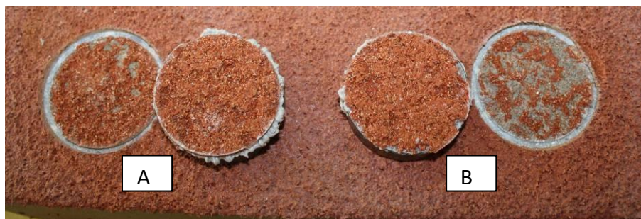
Afbeelding 1. Gescheiden oppervlakken na de tractietest. A) B: 100% Cohesiefout van de geprojecteerde kurk y B) Gemengde fout 50% A/B – 50% B: 50% adhesiefout tussen de geprojecteerde kurk en de betonsteun en 50% cohesiefout van de geprojecteerde kurk
